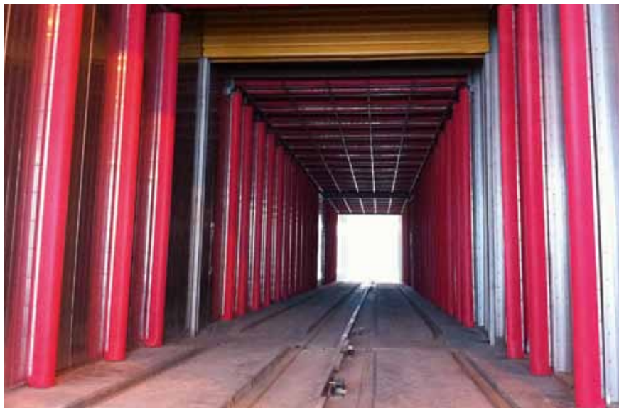
Bei Kanaltrocknern durchlaufen die Schnittholzpakete kontinuierlich die verschiedenen Klimazonen auf Schienen
