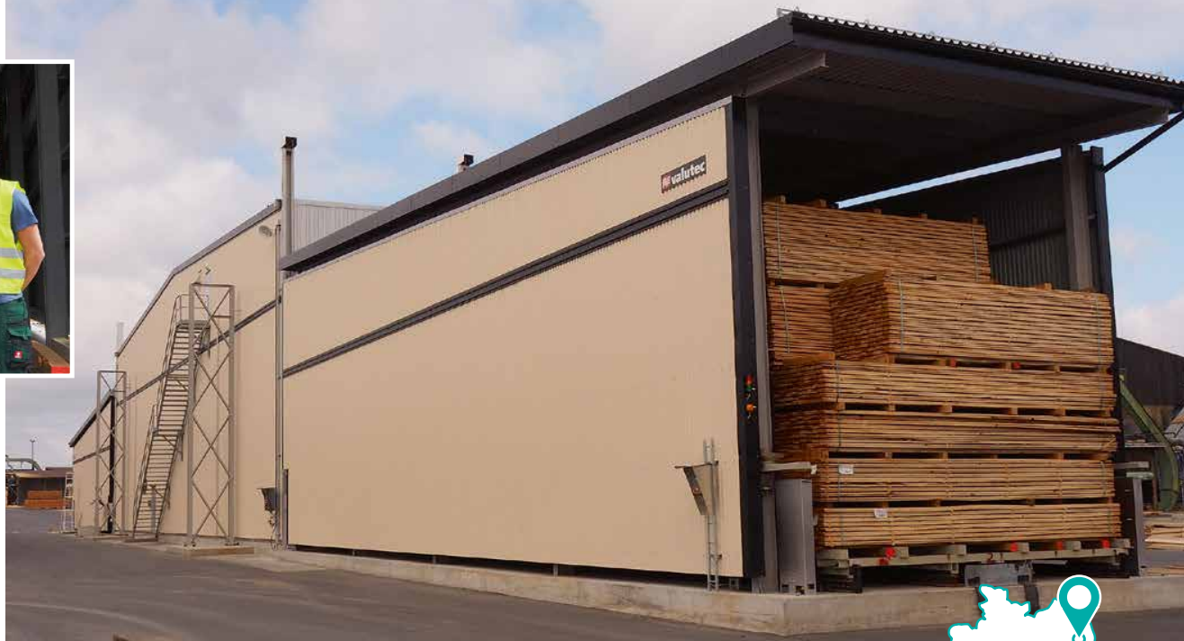
Imposant: 93 m misst der OTC-Kanaltrockner von Valutec bei Robeta, rechts die Abnahme der getrockneten Ware
