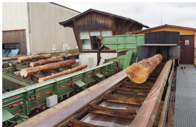
Investition am Langholzplatz: Scantec lieferte die neue Drevotec-Kapplinie (li.), die Vermessung stammt von Jörg Elektronik (li.).
