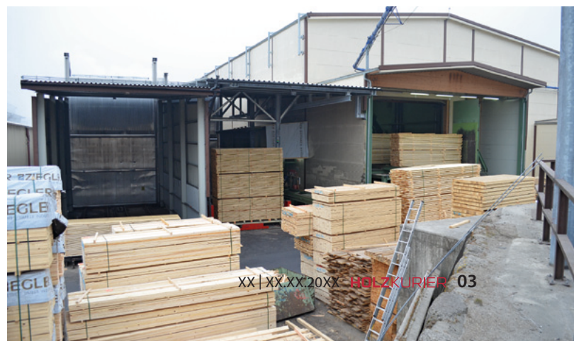
Wenig Platz: Der neue Kanaltrockner bei Ziegler wurde zwischen einem bestehendem Valutec-Kanal (li.) und einer Sägelinie errichtet
