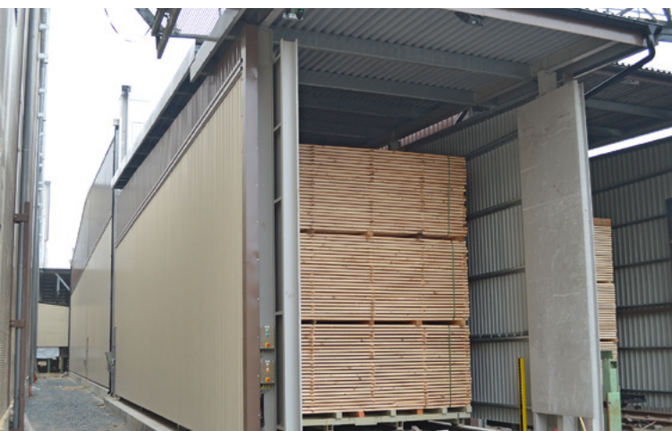
Der neue Valutec-OTC-Kanal trocknet bei Ziegler Holzindustrie 50.000 m 3 /J Schnittholz
